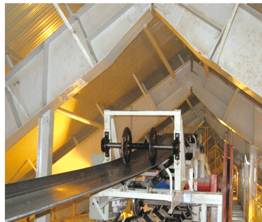
总长: 2881m 带宽: 650、800、1000、1200四种带宽 输送物料: 工艺上料、散装尿素、成品包装袋 装机功率: 5.5~132kw 输送量: 100~600t/h 投产日期: 2011年12月
